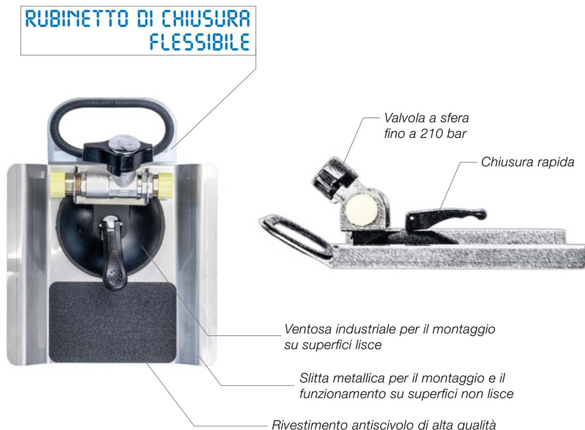
In alternativa a un radiocomando che taglia l'alimentazione della vostra pompa ad alta pressione, il blocco dell'acqua vi permette di interrompere l'alimentazione dell'acqua per fermare la rotazione della spazzola. Si tratta di una valvola a sfera ad alta pressione, montata su ventosa con slitta metallica.
