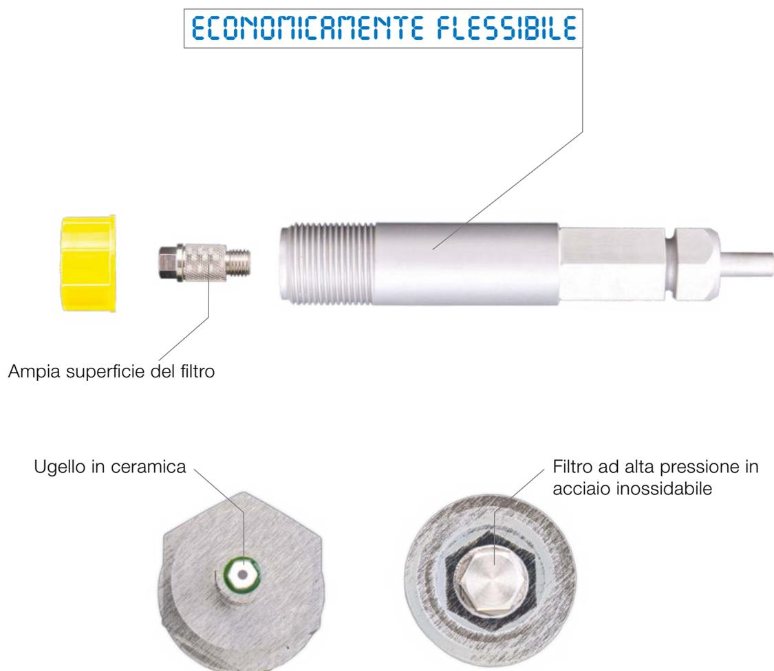
In tutti i SOLA-TECS C inseriamo di serie come dimensione standard un ugello da 9-l/min. Ciò corrisponde a un flusso d'acqua di 9 litri al minuto con una pressione dell'acqua di 100 bar.
