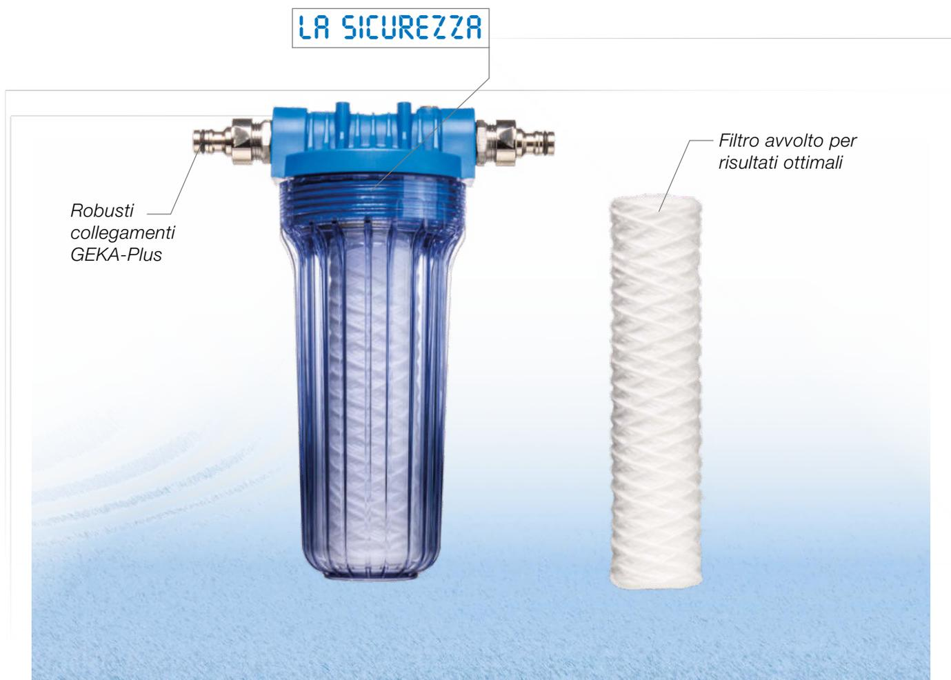
Il prefiltro è realizzato in corda di polipropilene e filtra le particelle più fini dell'acqua, come sabbia, sporcizia, materiale in sospensione, scaglie di calcare, ruggine ed eventualmente decolorazione. A causa della dimensione dei suoi pori, il filtro avvolgente non permette il passaggio di particelle più grandi di 1 µm.
